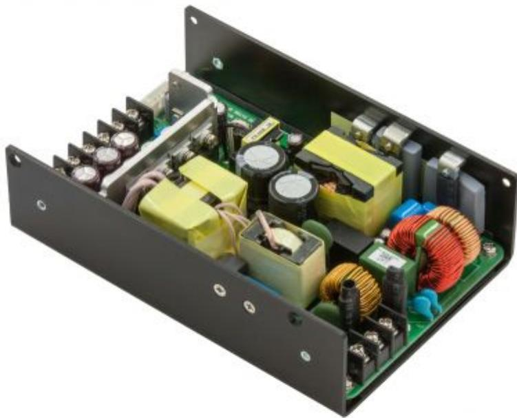
Die Open-Frame Netzteilserie B46600 von Power-Win erreicht eine Ausgangsleistung von bis zu 600 Watt mit Lüfter. Bis zu 340 Watt Leistung sind per Konvektionskühlung, auch mit Cover erreichbar. Das Netzteil arbeitet zuverlässig und verfügt über einen hohen Wirkungsgrad (93%). Ein weit gefasster Eingangsspannungsbereich von 90-264 VAC ermöglicht der Netzteilserie den weltweiten Einsatz. Das B46600 verfügt zusätzlich über
