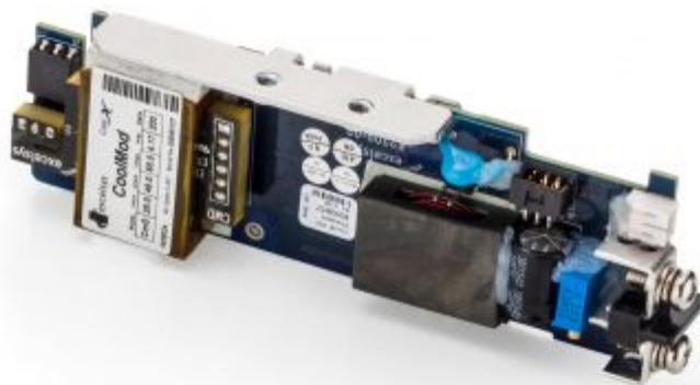
Für das Grundgerät [CoolX600](#) stehen verschiedene Module zur Verfügung, die je nach Bedarf individuell konfiguriert werden können. Die Module sind galvanisch voneinander getrennt und können sowohl parallel als auch in Serie betrieben werden. Hierdurch wird eine hohe Flexibilität gewährleistet. Gerne übernehmen wir die Konfiguration für Sie.
