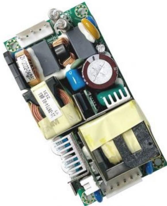
Die kompakte Open Frame Netzteilserie HBU250 von Sinpro erreicht eine Leistung von 150 Watt bei Konvektionskühlung und 250 Watt mit Lüfter - kurzzeitig ist sogar eine Peak Leistung von 300 Watt möglich.
