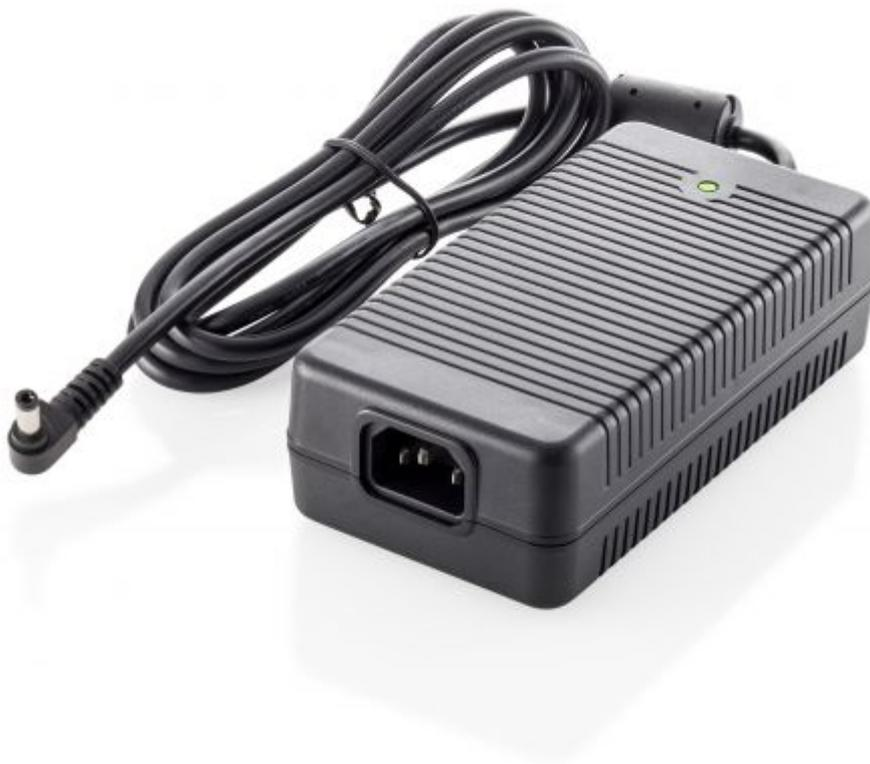
Das medizinische 100 W Tischnetzteil HPU101 ist mit einer Ausgangsspannung zwischen 12 V und 48 V erhältlich. Der ausgelegte Temperaturbereich für den Einsatz erstreckt sich von -10 °C bis 40 °C, mit Derating bis 70 °C. Mit einem Eingangsspannungsbereich von 90–260 Vac ist die Serie für den weltweiten Einsatz geeignet.
