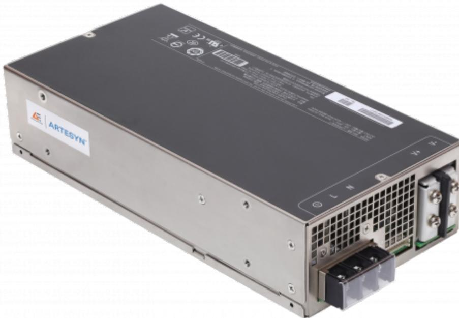
Die Netzteilserie LCM1000 von Artesyn erreicht eine Ausgangsleistung von 1000 Watt. Erhältlich ist das Netzteil in den Ausgangsspannungen 12V, 15V, 24V, 36V & 48V. Alle Ausgangsspannungen können angepasst werden (je nach Modell  $\pm 10\%$  oder  $\pm 20\%$  des Nennwertes). Ein Übertemperatur-, Kurzschluss- und Überspannungsschutz sowie alle notwendigen Zulassungen für die Nutzung in der Medizintechnik (IEC 60601-1) sind
