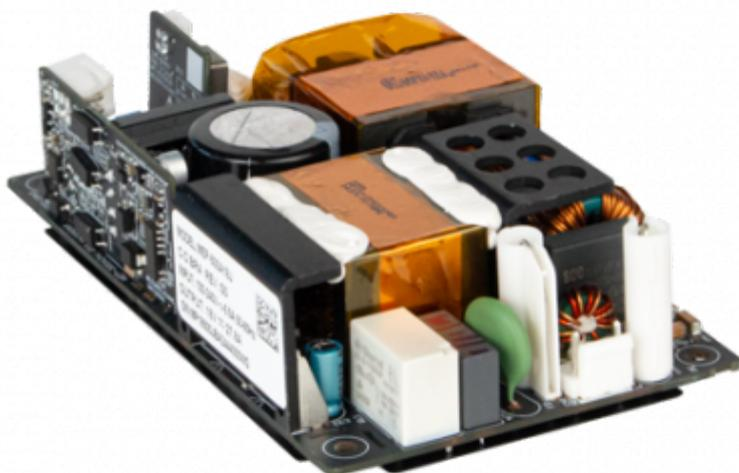
Das MEP-500A von Delta Electronics ist ein hocheffizientes Open-Frame-Netzteil im kompakten 3" x 5" Format. Es liefert bis zu 500W Ausgangsleistung mit aktiver Belüftung und 300W konvektionsgekühlt – ideal für Anwendungen, bei denen Platz, Effizienz und Sicherheit entscheidend sind.
