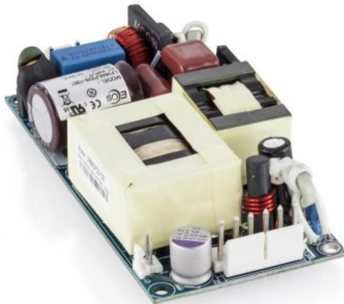
Die (M)WLP225 Serie von EOS Power ist eine kompakte Open Frame Netzteilserie mit einer Leistung von 225 Watt (belüftet). Bei Konvektionskühlung erreicht das (M)WLP225 eine Ausgangsleistung von 120 Watt. Die hohe Leistungsdichte sowie die Erfüllung relevanter Sicherheitsstandards ermöglichen einen vielseitigen Einsatz. Verschiedene Ausgangsspannungen im Bereich 12 - 58 Volt sind verfügbar und der Wirkungsgrad beträgt
