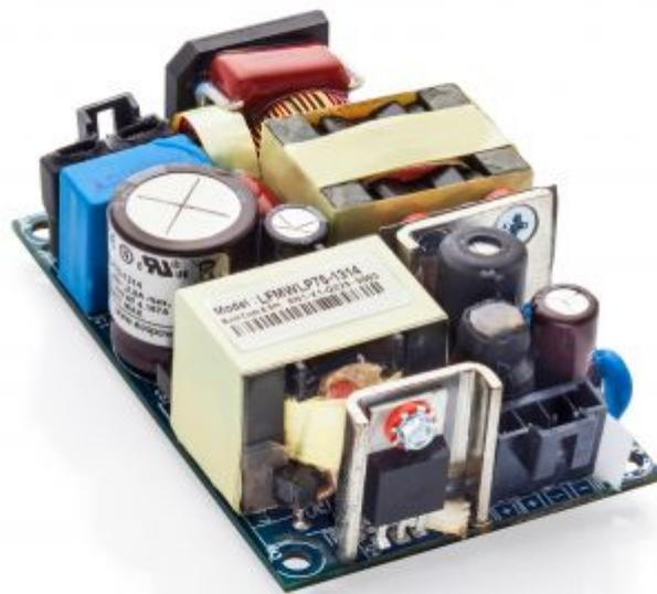
Bei der (M)WLP75 Serie von EOS Power handelt es sich um eine äußerst kompakte Open Frame Netzteilserie mit einer Leistung von 75 Watt bei Konvektionskühlung. Die hohe Leistungsdichte sowie die Erfüllung relevanter Sicherheitsstandards ermöglichen einen vielseitigen Einsatz. Der Wirkungsgrad beträgt bis zu 93% und der mögliche Temperaturbereich für den Betrieb des Netzteils liegt zwischen -40 bis +70°C. Verschiedene Ausgangsspannungen von 12 - 58 Volt sind verfügbar.
