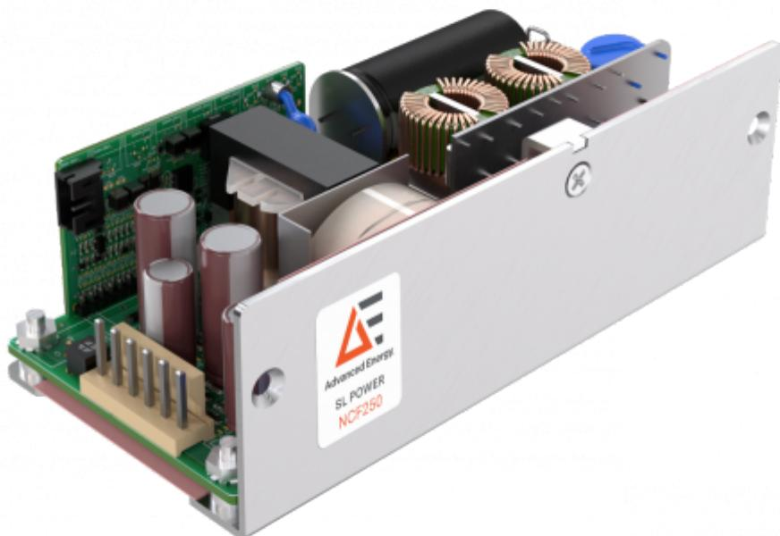
Die NCF250 Serie von Advanced Energy wurde speziell für medizinische Anwendungen entwickelt, die einen niedrigen Ableitstrom und die Anforderungen für Cardiac Floating (CF) gemäß IEC 60601-1 erfüllen müssen. Das Open Frame Netzteil liefert bis zu 250W Ausgangsleistung mit aktiver Belüftung bzw. 175W bei Konvektionskühlung – ideal für den lüfterlosen Einsatz in sensiblen Umgebungen.
