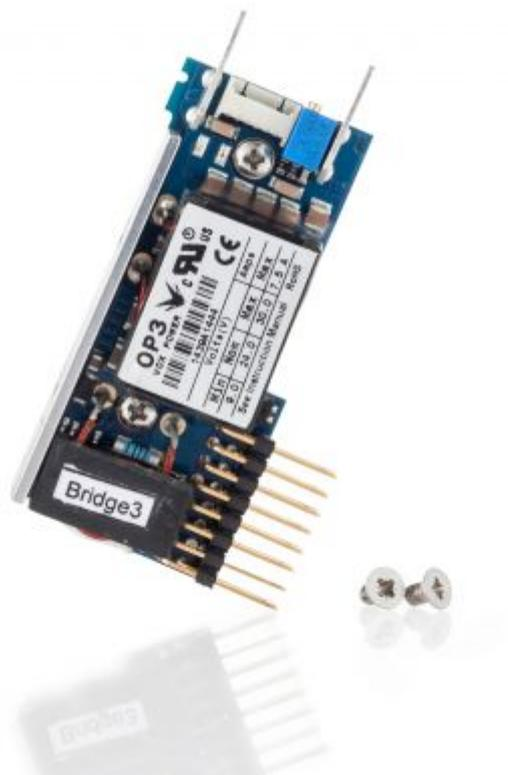
Für die Grundgeräte [Nevo+600](#) und [Nevo+1200](#) stehen verschiedene Module zur Verfügung, die je nach Bedarf individuell konfiguriert werden können. Die Module sind galvanisch voneinander getrennt und können sowohl parallel als auch in Serie betrieben werden. Hierdurch wird eine hohe Flexibilität gewährleistet. Gerne übernehmen wir die Konfiguration für Sie.
